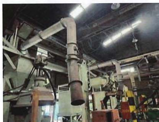
ภาพที่ 17 ระบบรวบรวมอากาศด้านบนเครื่อง shell core
